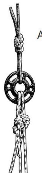
**Figura 3.** Doble estacionaria: Cuerdas dobles ancladas utilizando nudos en ocho trazados en una instalación de cuerda estacionaria.
